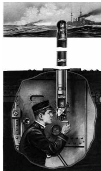
Простейшая форма перископа – труба, на обоих концах которой закреплены зеркала, наклонённые относительно оси трубы на  $45^\circ$  для изменения хода световых лучей. В более сложных вариантах для отклонения лучей вместо зеркал используются призмы, а получаемое наблюдателем изображение увеличивается с помощью системы линз. Предлагаем вам создать собственный перископ! Сделать это очень просто!
