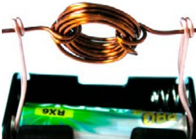
В случае, если собранный электродвигатель не вращается, не спешите расстраиваться. Чаще всего причиной отсутствия вращения мотора является слишком большое расстояние между магнитом и катушкой. В этом случае нужно всего лишь немного подрезать «скрепки», на которых держится вращающаяся часть.
