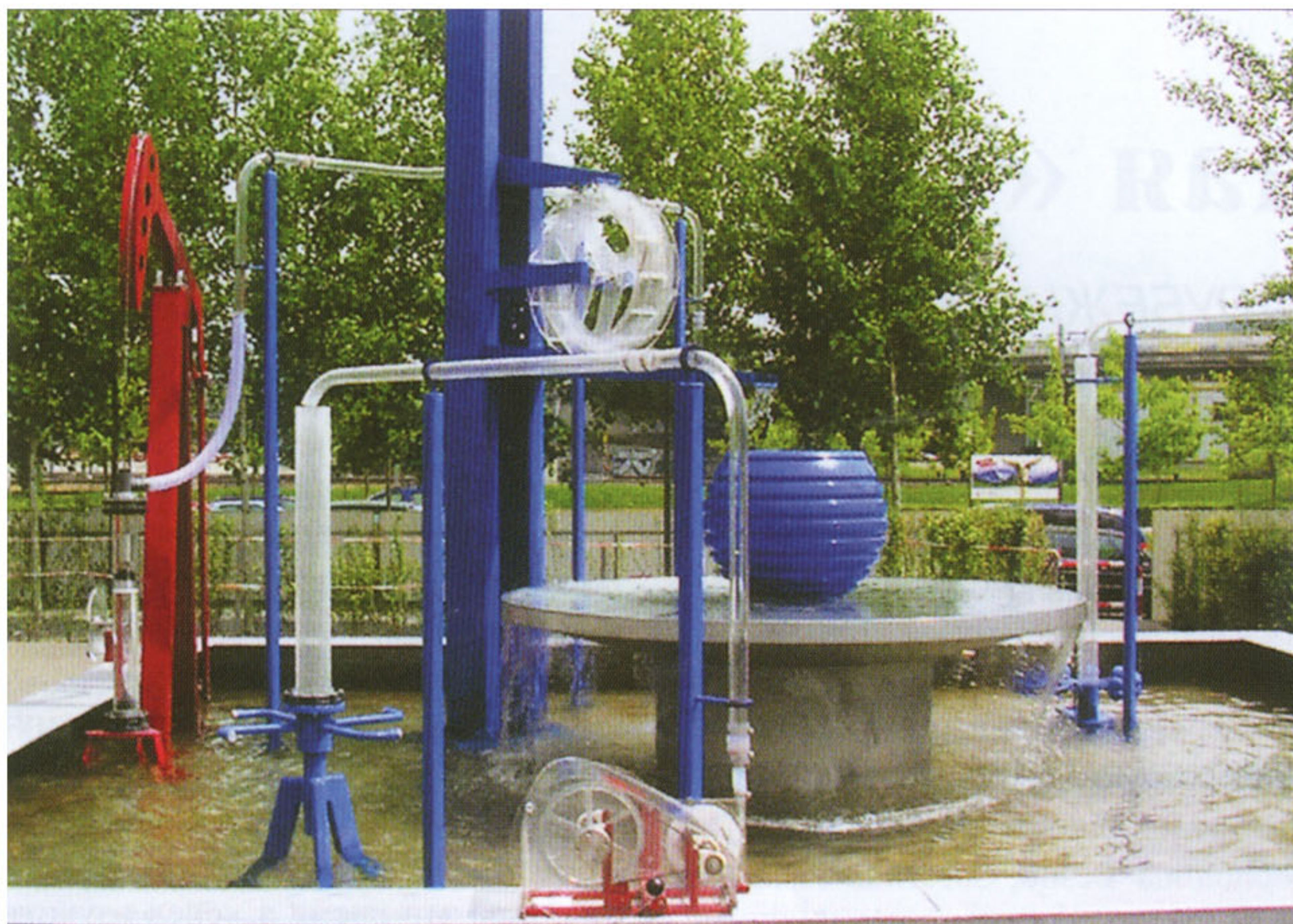
Бассейн с насосами, водяным колесом и самопрокидывающейся бочкой
