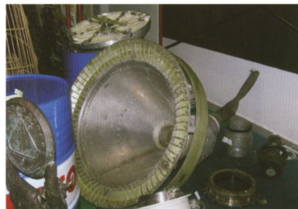
Конус от системы заправки топливом в воздухе стратегических бомбардировщиков Ту-95
